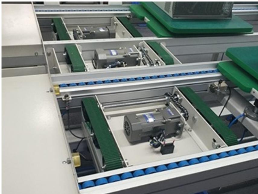
倍速链输送机特点有哪些？详细来说，倍速链输送机具备以下特点：1. 链式流水线是以链条作为牵引和承载体输送物料，链条可以采用普通的套筒滚子输送链，也可采用其它各种特种链条；2. 输送能力大，可承载较大的载荷；3. 输送速度准确稳定，能保证精确的同步输送；4. 易于实现积放输送，可用做装配生产线或作为物料的储存输送；5. 可在各种恶劣的环境（高温、粉尘）下工作，性能可靠[A]采用特制铝型材制作，易于安装[B]结构美观，实用噪音低[C]多功能，自动化程度高。智能倍速链组装线定做倍速链输送线的特点是：整个输送装置轻便、启动快捷。
