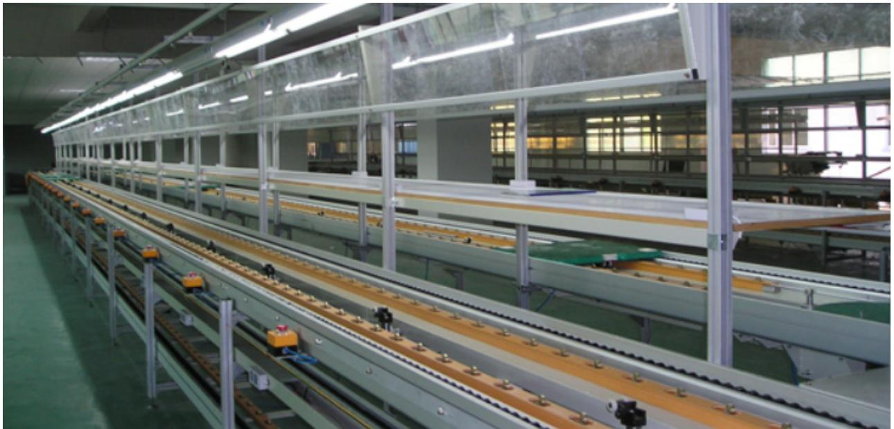
倍速链组装线操作流程；把电控箱里空气开关全部合上，然后把电控箱面板上的选择开关打开，按绿色按钮，系统启动。倍速链组装线操作流程：每一工位上有黑色和白色带箭头的两个按钮，按黑色时，该工位前面的暂存区有工装板，顶住工装板的阻挡器会下降，工装板在差速链的拖动下，到达与该工位平行的顶升移载机构时，旁边的阻挡器会顶住工装板，延时3秒，顶升移载机构气缸上升，上升到位后，滚筒向该工位转动，当碰到工作桌边行程开关时，该工位滚筒运转；按白色时，工位后的暂存区没有工装板，工位滚筒向线体方向运转，与该工位平行的顶升移载机构气缸上升，上升到位后，它上面的滚筒与工位滚筒同向运转，当碰到对面工作桌边的行程开关时，滚筒停转，顶升移载机构气缸下降，它旁边的阻挡器下降，工装板在差速链的拖动下，到达暂存区。
